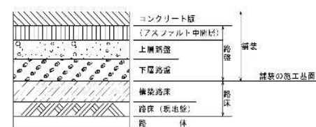
コンクリート舗装の基本的な構成
