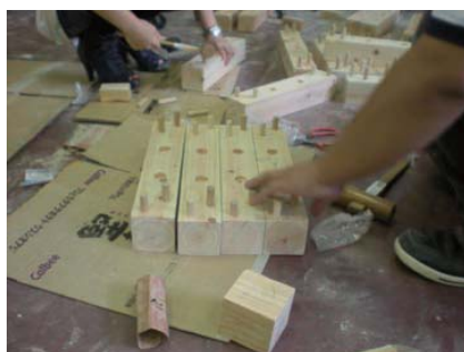
3. ダボを長部材の穴に打ち込む
