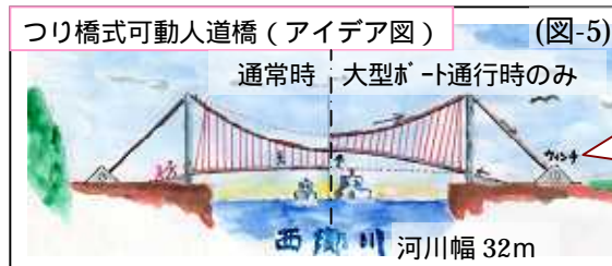
片側ワイフで、 上弦緊張と 下弦緩和で、 橋中央を2m 揚げる原理
